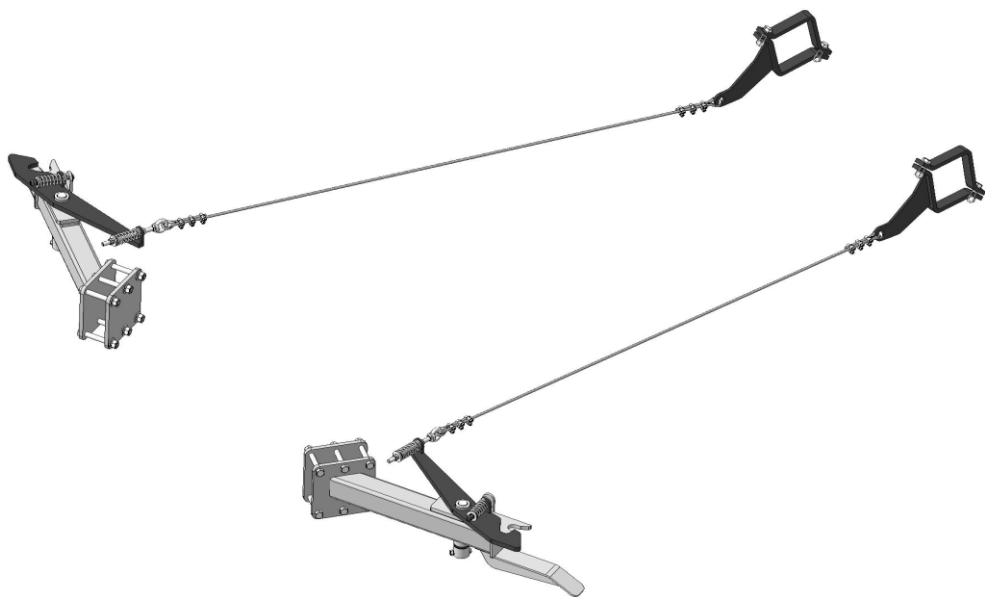
Рисунок 7 – Замки фиксаторы с тросами и рычагами.
